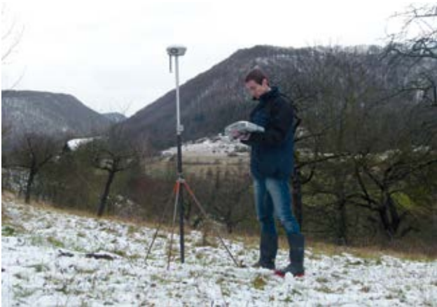
Vermessungstechniker des Landratsamts bei Vermessungsarbeiten mit einem hochpräzisen SAPOS-Empfänger
